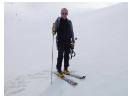
Fig. 2: esempio di test con sonda automatica Avatech SP2
